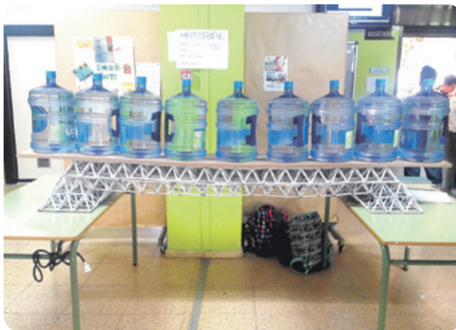
Este puente diseñado por los alumnos soporta hasta 200 kilos de carga. s.e.
